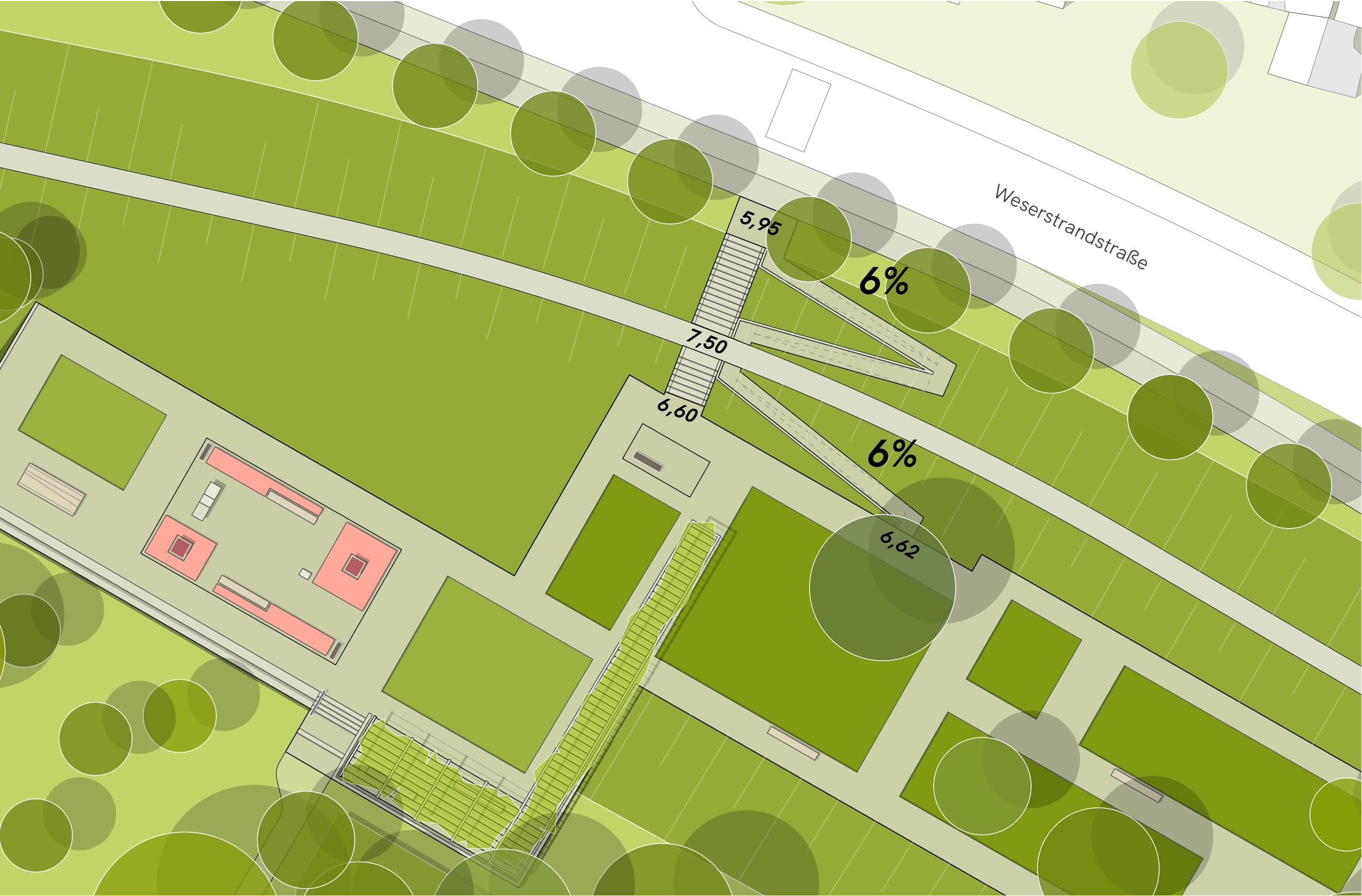
Gemeinsamer Zugang Treppenanlage und Rampe
